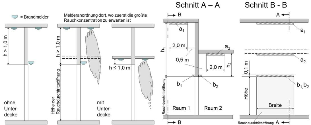
Bild 1: Maßgebende Höhe der Deckenunterfläche Bild 2: Installationsbereiche
